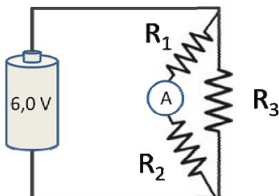
Determine a corrente medida pelo amperímetro A entre os resistores  $R_1$  e  $R_2$  em mA.
